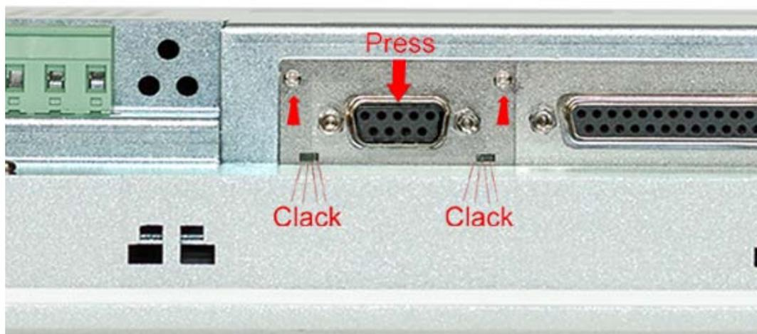
3. ➤ Drücken Sie jetzt das Schnittstellenmodul leicht nach unten, bis das Halteblech an den Haltenasen einrastet.
