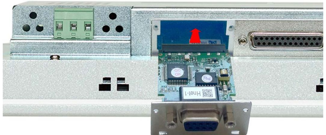
2. Führen Sie das zu montierende Schnittstellenmodul durch den Schacht ein. Schieben Sie das Schnittstellenmodul in das Gerät, bis das Halteblech am Gehäuse anliegt. Hierbei wird das Schnittstellenmodul durch die 2 innen liegenden Führungsleisten aufgenommen und in die richtige Position gebracht.
