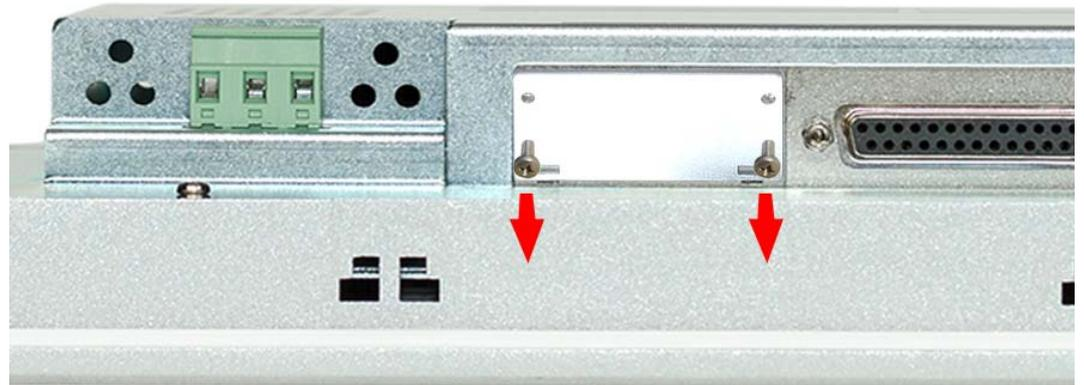
1. Entfernen Sie das Abdeckblech der COM3-Schnittstelle, indem Sie die Schrauben entfernen und das Blech abziehen.
